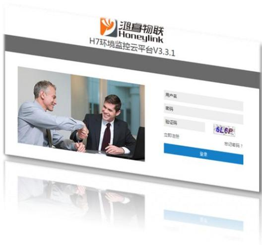
鸿睿物联H7冷链监控云平台软件部署在云服务器，用户只需要用户名与密码就可以远程登陆查看温湿度数据、报警信息、定位信息、设备管理、导出数据等操作。如温湿度超标，系统可发送短信给相关管理人员。
